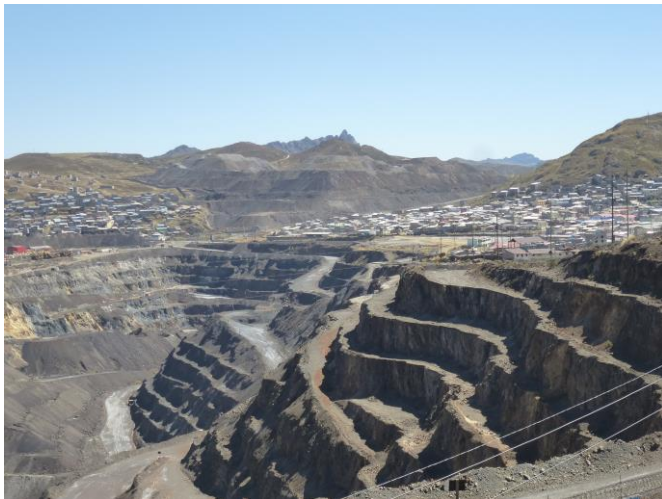
Cerro de Pasco. Offener Tagebau zur Förderung von Silber, Kupfer und Zink inmitten der Stadt.
